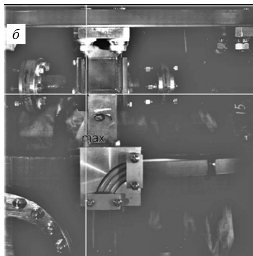
Рис. 3. Фотографии одной тороидальной катушки до рабочего импульса (а) и в момент рабочего импульса, когда её смещение максимально (б)
