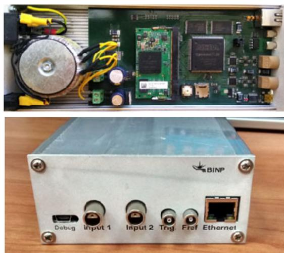
Рис. 13. Фотографии измерительного модуля дисперсионного интерферометра
