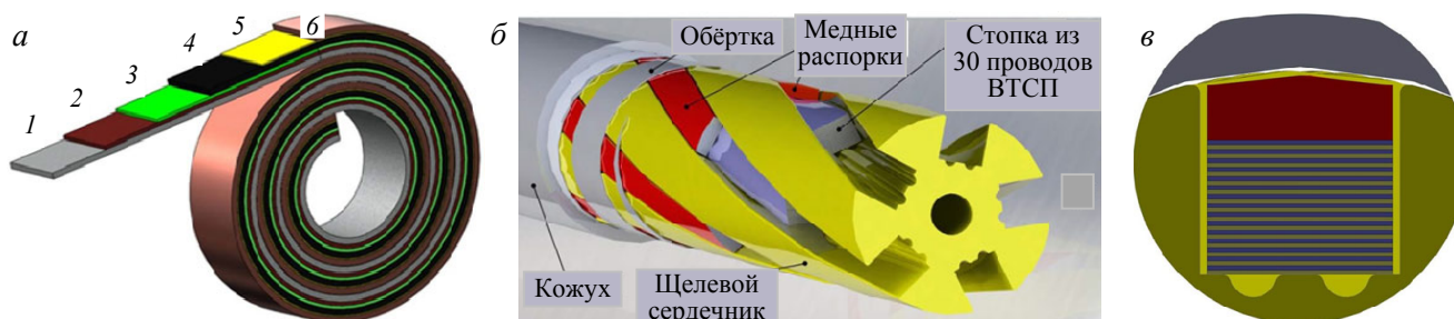
Рис. 1. Базовая архитектура провода ВТСП-2 [1]: 1 — несущая лента-подложка из нержавеющей стали толщиной 100 мкм (на рисунке толщина занижена почти в 50 раз); 2 — основной буферный слой YSZ, ~2 мкм; 3 — дополнительный буферный слой \text{CeO}_2 ; 4 — сверхпроводник YBCO (REBCO), 1–2 мкм; 5 — защитный слой серебра, <1 мкм; 6 — медный стабилизирующий одно- или двусторонний слой, 25 мкм (а); конструкция высокопрочного кабеля для термоядерных установок [2] (б) с пятью витыми стеками (стопками) из тридцати проводов ВТСП каждый (в)
