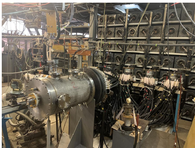
Рис. 1. Общий вид установки: на переднем плане вакуумная камера, далее правее виден ряд разрядников и конденсаторы
