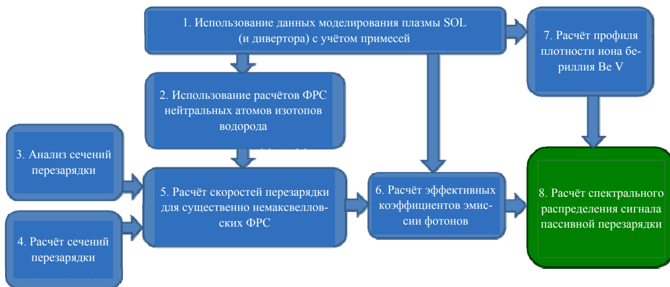
Рис. 2. Общая схема алгоритма моделирования пассивного сигнала
