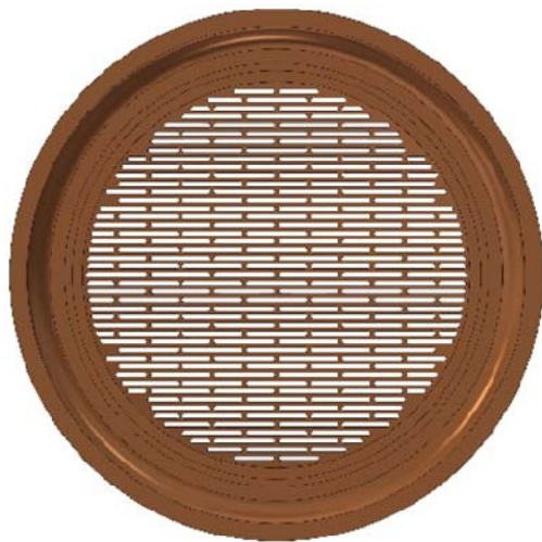
Рис. 5. Расположение щелей в начальном варианте плазменного электрода
