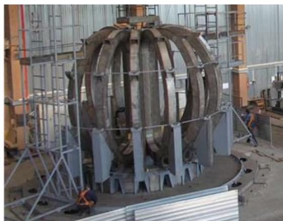
Рис. 11. Обмотка тороидального поля, состоящая из 16 катушек
