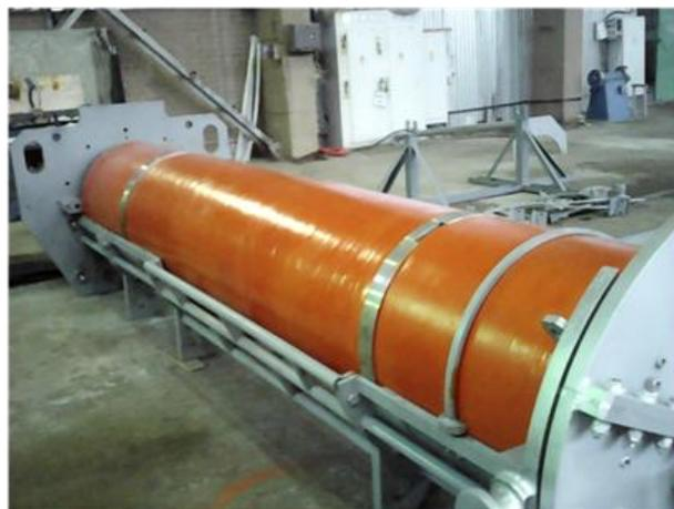
Рис. 14. Трёхсекционный индуктор
