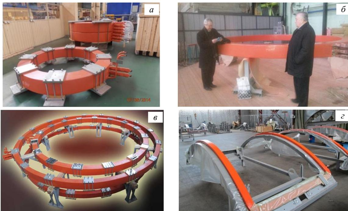
Рис. 15. Обмотки управления: ОУ1 и ОУ6 (а); ОУ2 (б); ОУ3, ОУ4, ОУ5 (в); катушки обмотки управления ОГУП (г)
