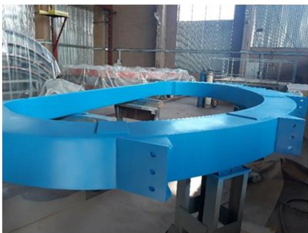
Рис. 13. Катушка ОТП внутри D-образного корпуса
