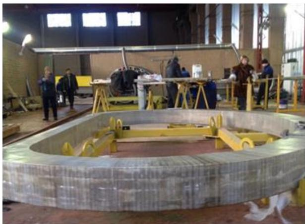
Рис. 12. Катушка ОТП после намотки и запечки
