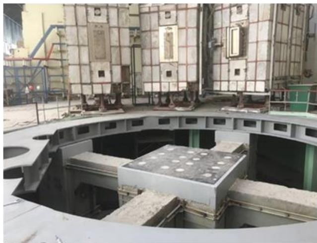
Рис. 9. Кольцевая опорная ферма на фундаменте токамака Т-15
