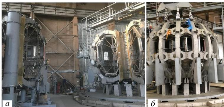
Рис. 23. 3/4 ОТП с тремя секциями вакуумной камеры и монтажный модуль (а); полностью собранная ОТП с четырьмя секциями вакуумной камеры (б)
