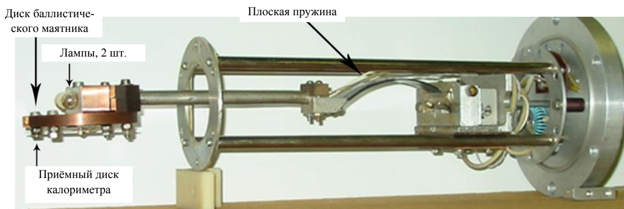
Рис. 3. Фотография баллистического маятника-калориметра
