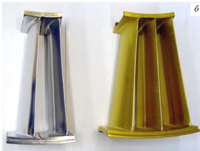
Установка «Виктория-2» (а) и стойки и сегменты (б) направляющего аппарата ГПА АЛ-31СТ с покрытием Ti + TiN
