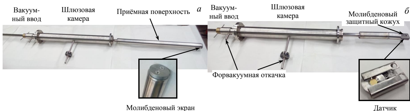
Рис. 8. Изготовленное устройство сбора лития для токамака Т-10: в форме гладкого цилиндра (а); в форме диагностического зонда (б)
