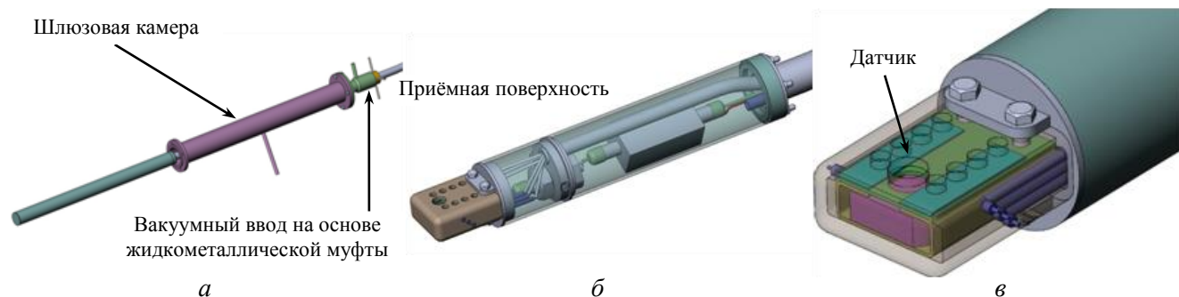
Рис. 7. Устройство сбора лития для токамака Т-10: в форме гладкого цилиндра (а); в форме диагностического зонда (б, в)
