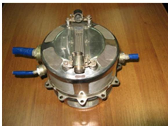
Рис. 4. Ионный двигатель «Зефир»: вид двигателя со стороны щелевой ионно-оптической системы, над ней размещены два источника электронов («нейтрализаторы», основной и резервный)
