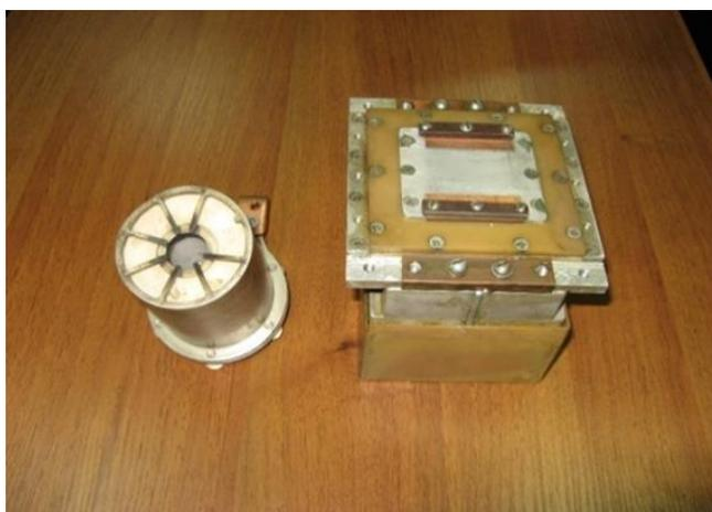
Рис. 1. Первая лабораторная модель первого в мире ИПД: разрядная камера и блок конденсаторов — накопителей энергии
