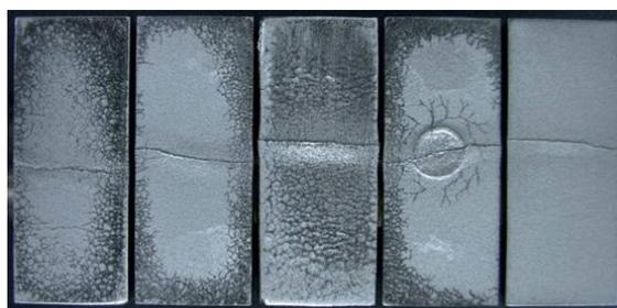
Рис. 9. Фотография моноблоков вольфрама ITER-grade марки A.L.M.T. Corp. после плазменно-тепловых испытаний в плазменной пушке и электронным пучком. На поверхности образуются большие трещины
