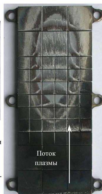
Испытания вольфрамовых моноблоков сорта ITER-grade корпорации A.L.M.T. Corp. плазменным пучком в совокупности с электронным пучком (25 плазменных импульсов мощностью  $\sim 2,0$  МДж·м<sup>-2</sup> и электронный пучок JEBIS с параметрами: 20 МВт·м<sup>-2</sup>, длительность 10 с, 300 циклов [68]) также привели к образованию трещин в зоне оплавления поверхности вольфрама (рис. 8).
