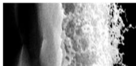
Рис. 35. СЭМ-изображение пористого вольфрама, образованного в гелиевой плазме в установке PISCES-B: температура подложки 1200 К, время экспозиции 4290 с, поток ионов гелия  $\text{He}^+ 2\cdot 10^{26}$  частиц/м<sup>2</sup>, энергия ионов гелия 45 эВ [117]
