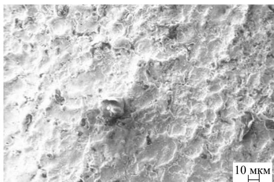
Рис. 40. Микрофотография СЭМ поверхности вольфрамового зонда после эксплуатации в плазме токамака T-10, наблюдается шероховатая структура
