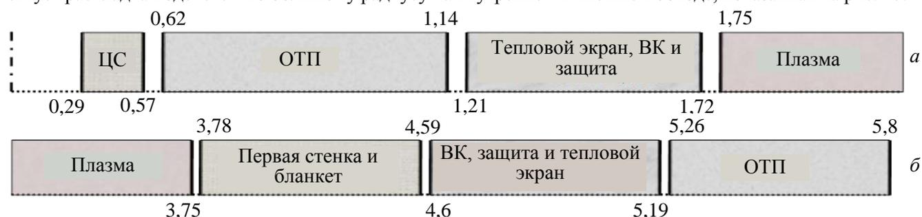
Рис. 17. Раскладка подсистем ДЕМО-ТИН по большому радиусу на внутреннем (а) и внешнем обводе (б) (указано расстояние границ подсистем от центральной оси токамака, м)
