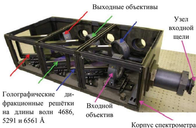
Рис. 12. Прототип спектрометра для CXRS диагностики Т-15
