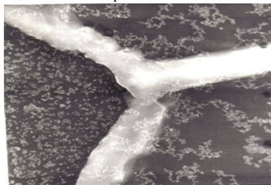
Рис. 2. Образование оксида (светлые полосы) на разных кристаллографических плоскостях (нагретый шлиф в вакууме в присутствии паров кремния)
