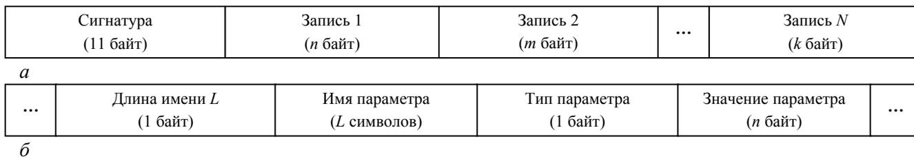
Рис. 3. Структура транспортного файла в формате TFile (а) и структура поля паспорта данных (DASPassport) (б)
