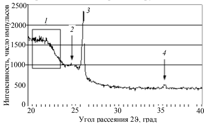
Рис. 10. Дифрактограмма пыли, собранной с плитки 2, которая показывает присутствие аморфной фазы (2, гало)
