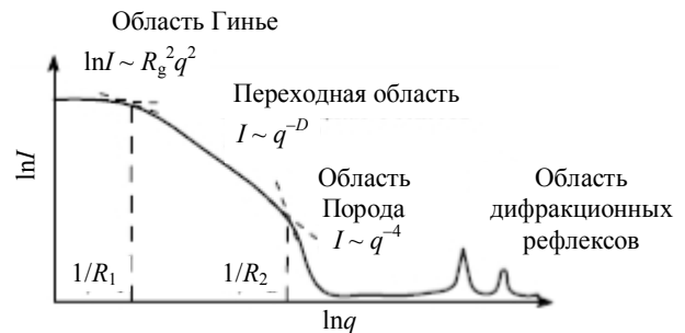
Рис. 3. Типичный вид кривой интенсивности I малоуглового рентгеновского рассеяния в широкой области переданных импульсов q \sim 10^{-3}—100 \text{ нм}^{-1} : R_1 — радиус агрегатов; R_2 — радиус частиц, составляющих фрактальный агрегат; R_g — радиус инерции агрегата; D — фрактальная размерность [19]
