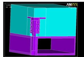
Рис. 1. Симметричная четверть графитовой плитки, фрагмента панели первой стенки
