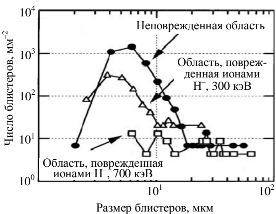
Рис. 9. Распределение размеров блистеров при различных значениях энергии создавших их ионов
