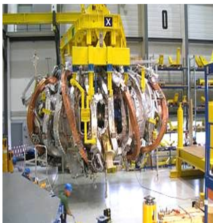
Рис. 2. Сборка первого модуля магнитной системы закончена (а), модуль доставлен на монтажный стенд для присоединения электрических шин и охлаждающих гелиевых трубок (б) (из лекции Л. Вегенера)
