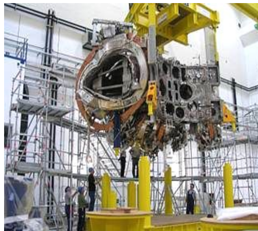
Рис. 2. Сборка первого модуля магнитной системы закончена (а), модуль доставлен на монтажный стенд для присоединения электрических шин и охлаждающих гелиевых трубок (б) (из лекции Л. Вегенера)
