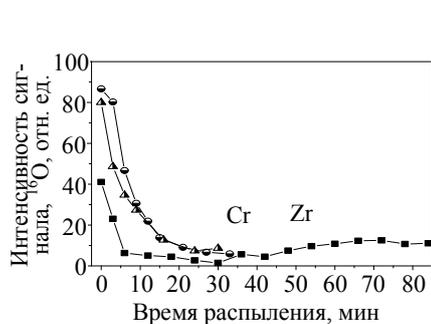
Рис. 1. Диаграмма интенсивности сигнала по кислороду (ВИМС): ■ — № 11; ● — № 18; ▲ — № 19
