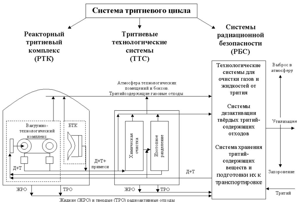
Рис. 1. Системы тритиевого цикла термоядерного реактора
