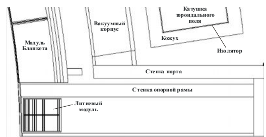
Рис. 2. MCNP-модель модуля — вертикальное поперечное сечение Рис. 3 MCNP-модель модуля (длинная опорная рама) — горизонтальное поперечное сечение
