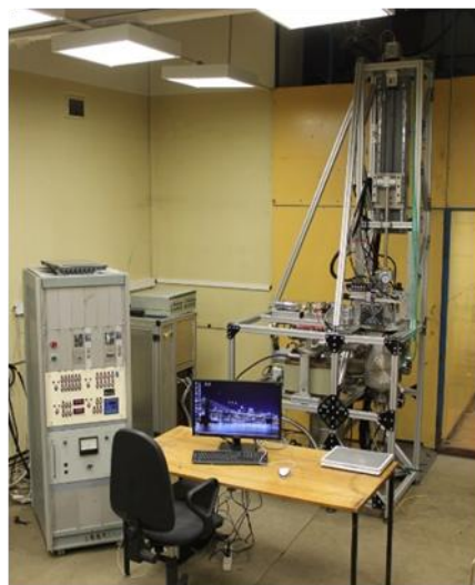
Рис. 2. Общий вид установки СОПТМАТ (а) и схемы установки в режиме напыления и тестирования (б): 1 — плазменная камера; 2 — накаливаемый катод; 3 — анод; 4 — внешний антидинаatronный электрод; 5 — внутренний антидинаatronный электрод; 6 — мишень; 7 — подложка для напыления; 8 — тестируемый образец; ↔ — откатка; ↑ — охлаждение; ↘ — поток ионов; → — поток распылённых атомов
