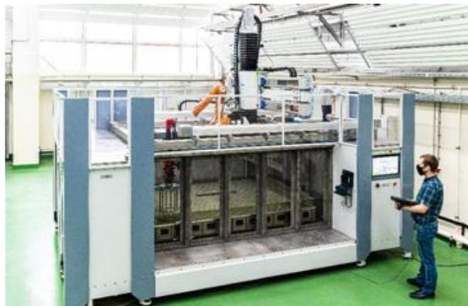
Рис. 10. Оборудование для контроля и испытаний паяного соединения: *а* — роботизированный комплекс УЗК; *б* — стенд «Цефей-М» для тепловых испытаний
