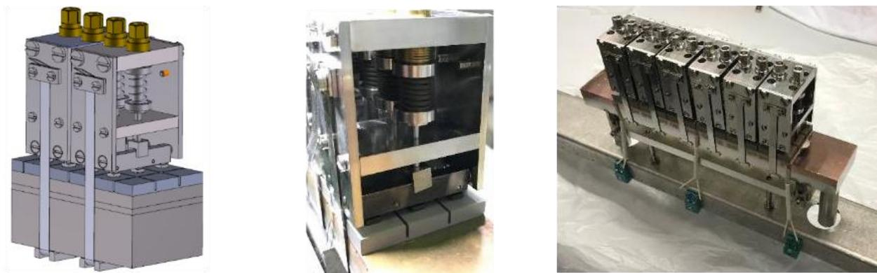
Рис. 6. Общий вид прижимных блоков фиксирующей оснастки
