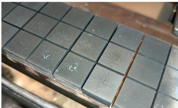
Рис. 13. Внешний вид поверхности бериллиевых плиток после 30 000 термоциклов при 4,7 МВт/м<sup>2</sup>
