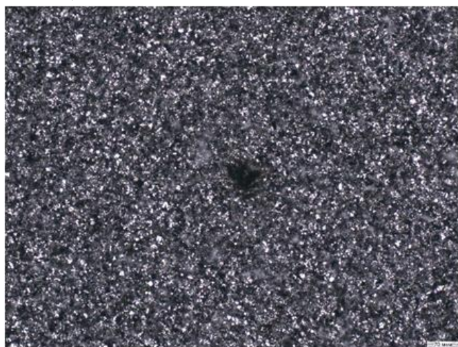
Рис. 13. Внешний вид дефекта типа «прижог»
