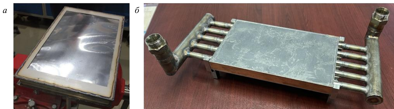
Рис. 3. Макет с покрытием из нержавеющей стали: до ГИП (а) и после ГИП и сварки коллекторов (б)
