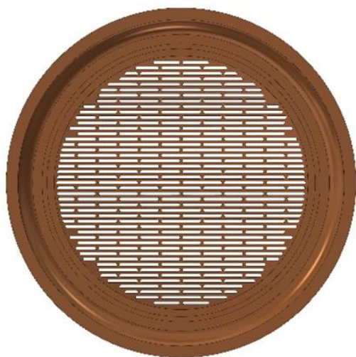
Рис. 5. Расположение щелей в начальном варианте плазменного электрода
