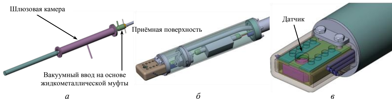
Рис. 7. Устройство сбора лития для токамака Т-10: в форме гладкого цилиндра (а); в форме диагностического зонда (б, в)
