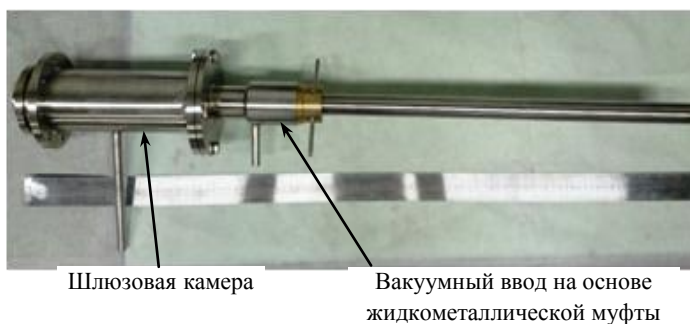
Рис. 6. Изготовленное устройство сбора лития токамака Т-11М с вакуумным вводом на основе жидкометаллической муфты
