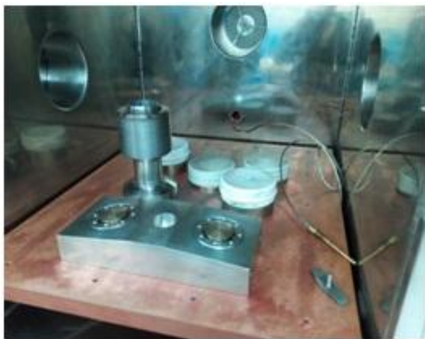
Рис. 11. Термовакуумные испытания КЭИН: а — объекты испытаний на термоплите вакуумной камеры; б — типовая диаграмма термовакуумных испытаний: — температура на плите; — заданная температура; — температура внизу плиты; — заданное давление; — измеренное давление
