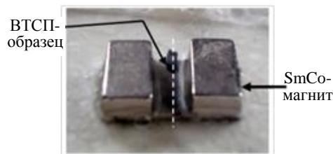
Рис. 20. ВТСП-образец выстраивается внутри PMG-системы вдоль линии минимальной магнитной индукции. ВТСП-образец приготовлен в ФИАН на основе керамики YBa_2Cu_3O ( T_c \sim 91 К, H_c \sim 5,7 Тл при 0 К)
