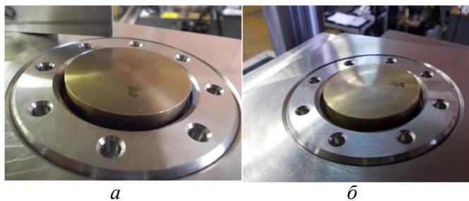
Рис. 11. КЭИН № 2 (а) и № 7 (б) (цилиндрическая боковая поверхность с ЭИП) после испытаний
