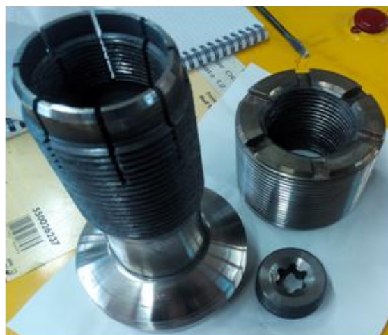
Рис. 24. Элементы системы крепления перед испытанием
