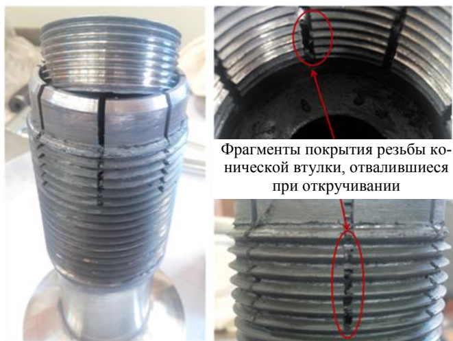
Рис. 26. Элементы системы крепления после испытания
