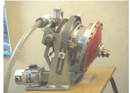
Рис. 4. Мишенное устройство диаметром 230 мм
