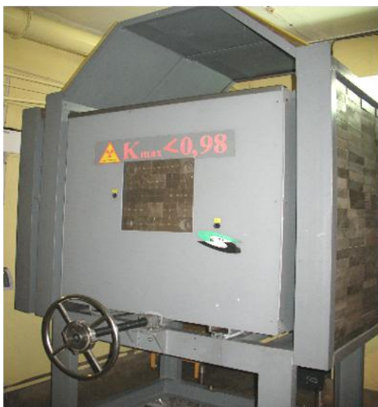
Рис. 1. Подкритическая уран-полиэтиленовая сборка Яліна-Тепловая
