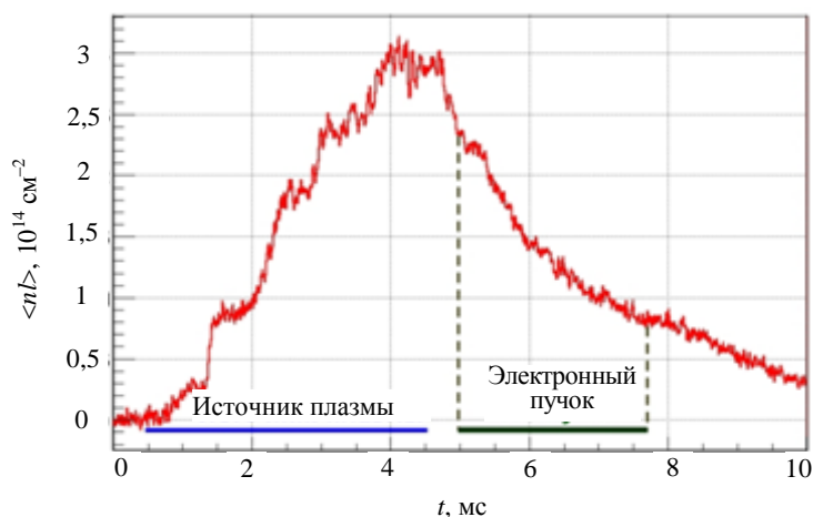
Рис. 4. Зависимость линейной плотности плазмы от времени. Указаны промежутки времени, в котором работает плазменный генератор, и промежутки, в котором включался электронный пучок
