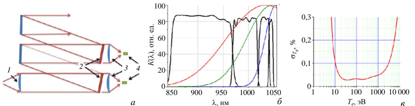
Рис. 2. Принципиальная схема фильтрового спектрометра (а): 1 — входной объектив, 2 — спектральный фильтр, 3 — объектив, 4 — приёмник; б — спектральные характеристики каналов спектрометра и наложенные спектры томсоновского рассеяния; в — кривая ошибок измерения температуры для выбранного набора спектральных каналов полихроматора
