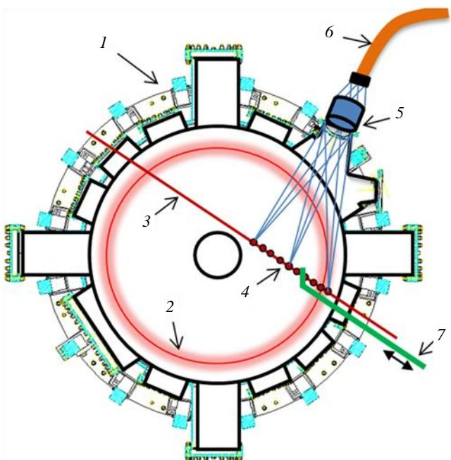
Рис. 1. Размещение диагностики томсоновского рассеяния на токамаке Глобус-М: 1 — сечение камеры в экваториальной плоскости; 2 — внешняя граница плазмы; 3 — зондирующий лазерный пучок; 4 — точки наблюдения; 5 — объектив; 6 — оптоволоконная линия; 7 — система контроля юстировки
