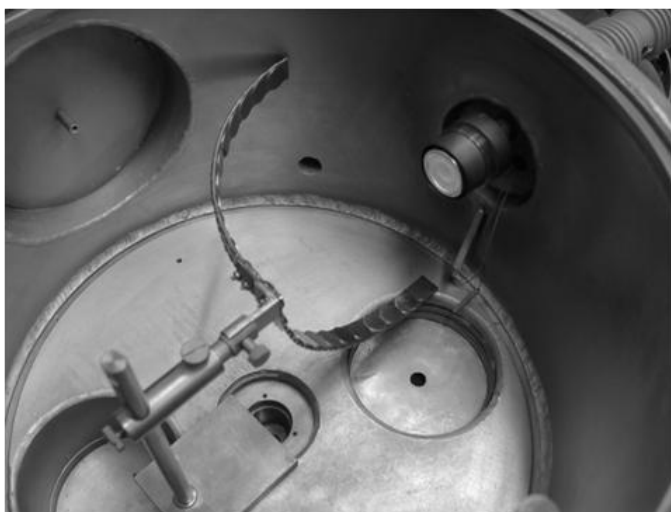
Рис. 1. Взаимное расположение распылительного магнетрона и держателя измерительных марок в вакуумной камере
