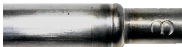
Рис. 13. Периметрическое сварное соединение стали ЭК-181, выполненное аргодуговой сваркой (АДС)
