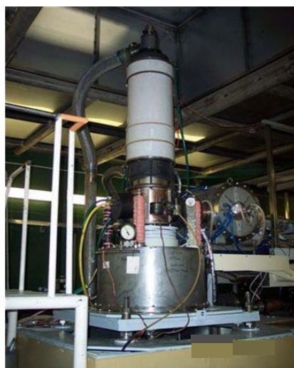
Рис. 1. Гиротроны Везувий-9 (а) и Везувий-10 (б) на испытательном стенде
