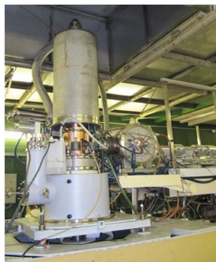
Рис. 1. Гиротроны Везувий-9 (а) и Везувий-10 (б) на испытательном стенде
