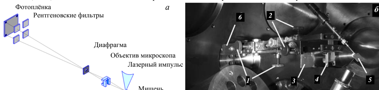
Рис. 2. Схема (а) и внешний вид (б) четырехканального рентгеновского микроскопа: 1, 2 — юстировочные винты; 3 — диафрагма; 4 — четырехканальный объектив рентгеновского микроскопа; 5 — мишень; 6 — кронштейн
