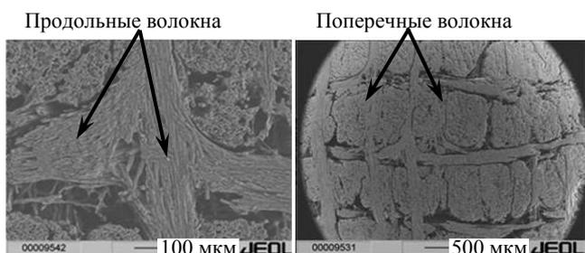
Рис. 9. Структура поверхности SEP NB31 после 200 плазменных импульсов ( $q = 10$  МДж/м<sup>2</sup>,  $\tau = 50$  мкс) на установке МК-200. Снимки получены на электронном микроскопе JEOL
